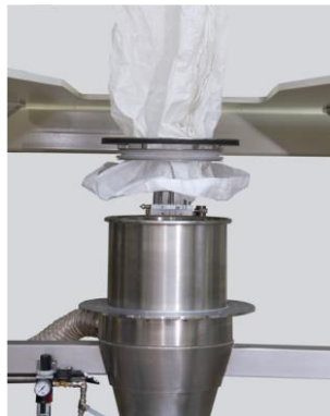
Big-Bag Auslauf durch den Dichtring ziehen.
