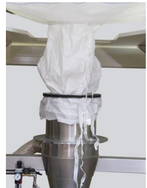
Der Ring senkt sich, die Blähdichtung dichtet das System ab.
