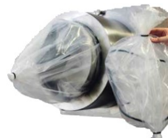
Liner trennen und ausgeschleustes Produkt entsorgen
